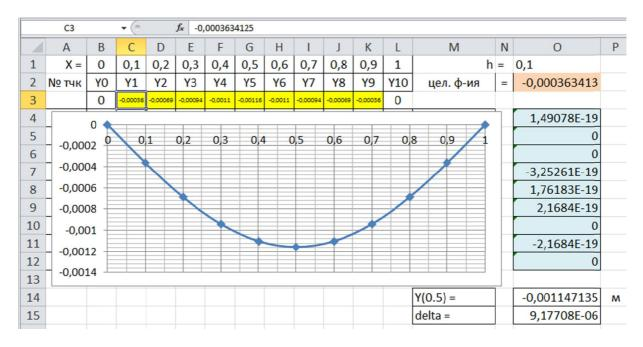
Погрешность расчета составила 0,0000092 м = 0,0092 мм = 9,2 мкм
