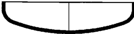
Рис. Днище сферическое отбортованное
