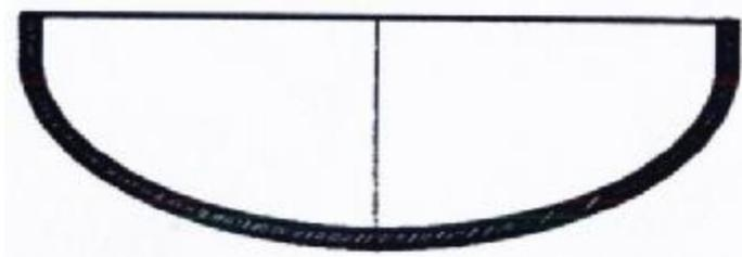
Рис. Днище эллиптическое
