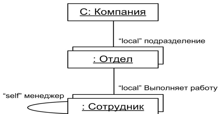
Рис. 9. Графическое изображение связей с различными стереотипами
