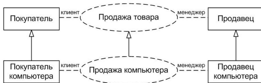
Рис. 2. Графическое изображение отношения обобщения между отдельными кооперациями уровня спецификации
