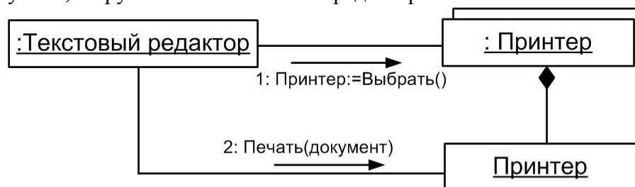
Рис. 7. Фрагмент диаграммы кооперации для вызова функции печати из текстового редактора
