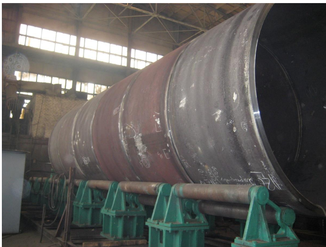
Рисунок 4 – Цельносварная цилиндрическая оболочка для корпуса колонного аппарата.
