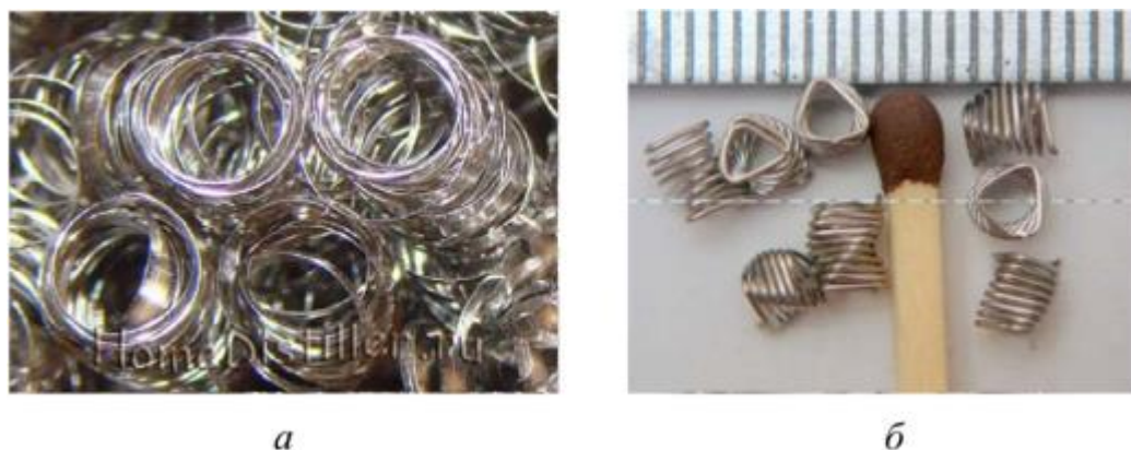
Рис. 2.14. Нерегулярная насадка из мочалок (а) и спиральной проволоки (б)
