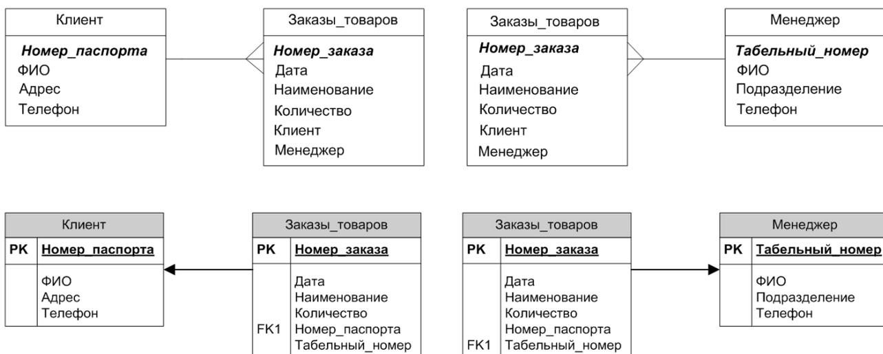
Рис. 4.3. Изображение связи между сущностями в нотации Баркера (сверху) и MS Visio (снизу)
