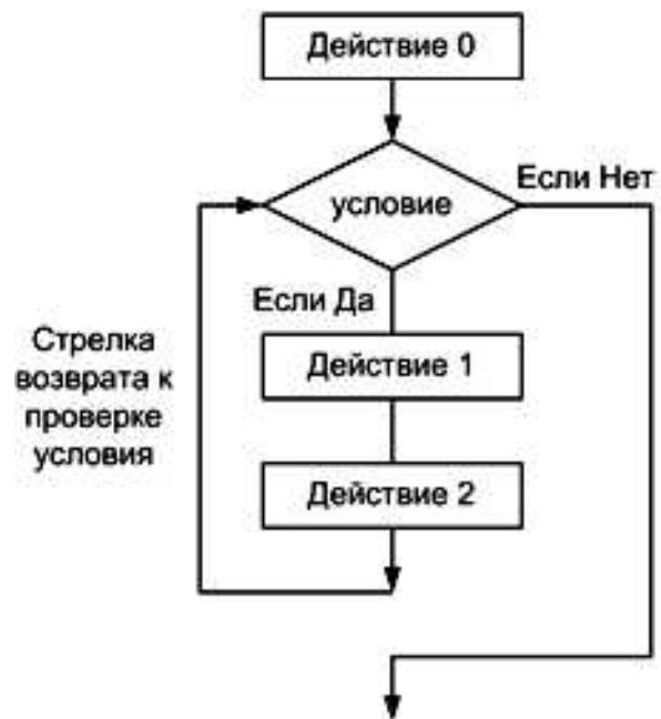
Рис. 11.14. Блок-схема алгоритма с циклом While
