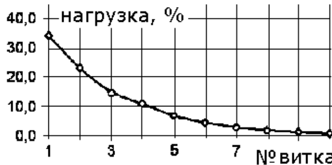
Рис. 7.4 – Распределение нагрузки по виткам резьбы
