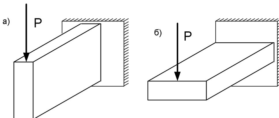
Рис. 1. Влияние формы сечения на величину деформации при изгибе
