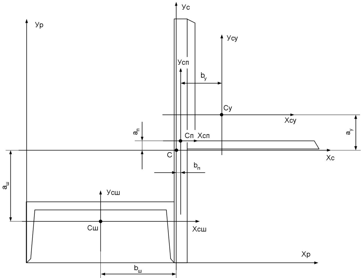
Рис. 6. Пояснения к расчету расстояний между центральными осями каждого элемента и всего составного сечения.
