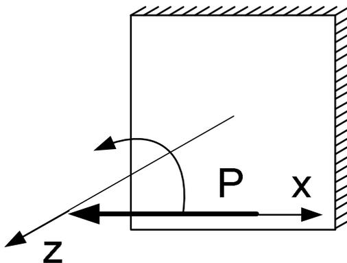
Рис. 3. Выбор направления силы для обеспечения наименьшей деформации
