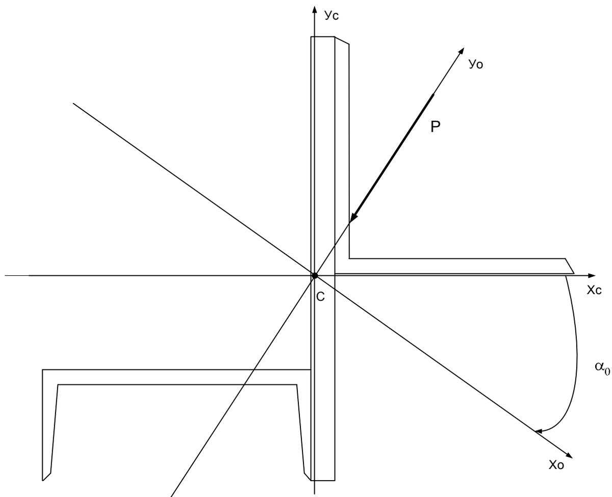
Рис. 7. Положение главных центральных осей составного сечения.
